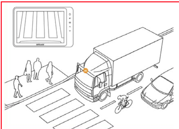
No hay peatones dentro del área de detección
